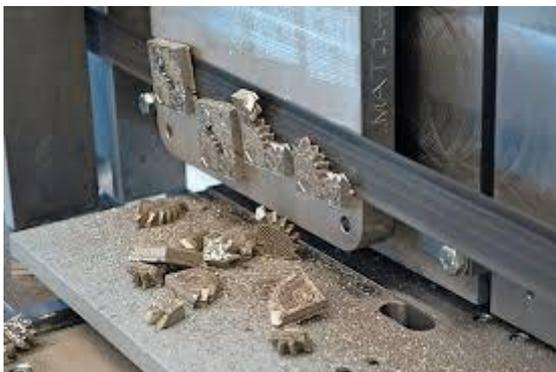
Ausserdem druckt EBM weniger detailliert mit rauerer Oberfläche, bspw 25 vs 10 $\mu$ m beim SLM. Es können auch nur sehr begrenzt reaktive pulverförmige metallische Werkstoffe genutzt werden. Allerdings sind interne Druck-Schubspannungen viel weniger vorhanden als bei SLM Produkten, die daher häufig erst teure Druckplatten aus dem gleichen Material erstellen/drucken müssen um Verzug zu vermeiden. Danach müssen die Teile tlw. Mittels einer Säge von der Druckplatte getrennt werden, siehe Photo.
