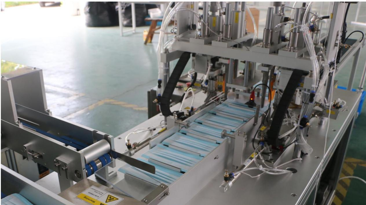
Ohrschleifenschweissanlage von MNS. Wir benötigen andere Geometrien, Positionen und Lagen (Maske gedreht).
