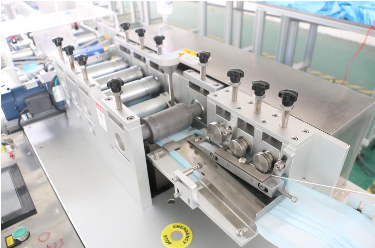
Maskenschweissung. Wir benötigen hier keine Nasenbügelzuführung an dieser Stelle, eine breitere Führung, einen anderen Trennschnitt, dünnere Schweissnähte anderer Geometri, weitere Faltungen und Schweissungen.
